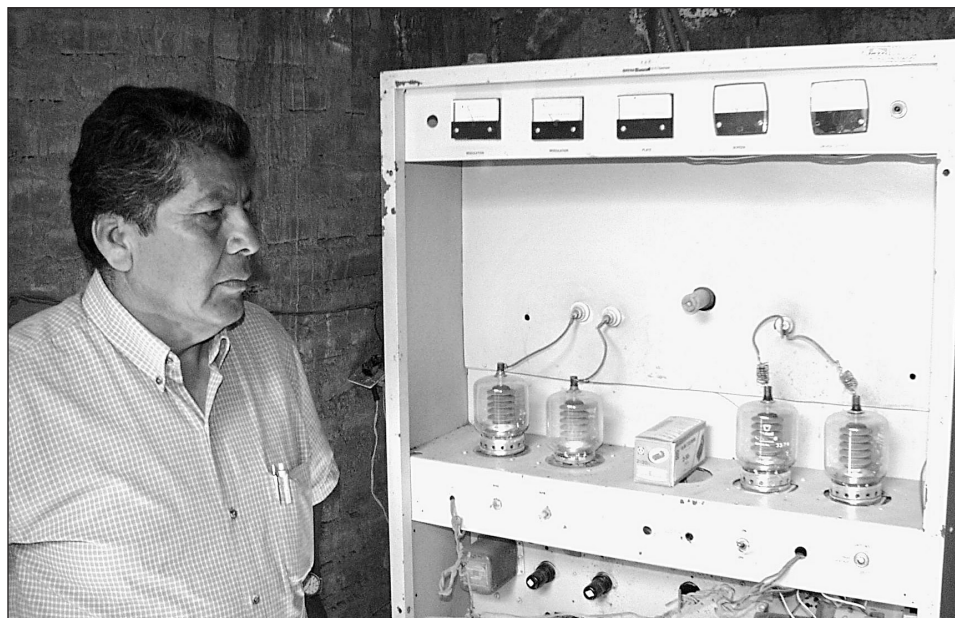
Celso Valdglesias ved radiosenderen. Dette er en svært umoderne sender som bruker mye strøm og gir dårlig lydqualität. Legg merke til radorørerne! Dette er gammel teknologi som de nå ønsker å bytte ut med moderne transistorer.
